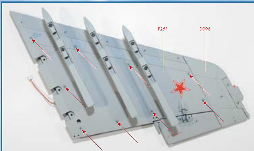
**4** Закрепите нижнюю поверхность консоли крыла винтами NM в местах, указанных на снимке.
