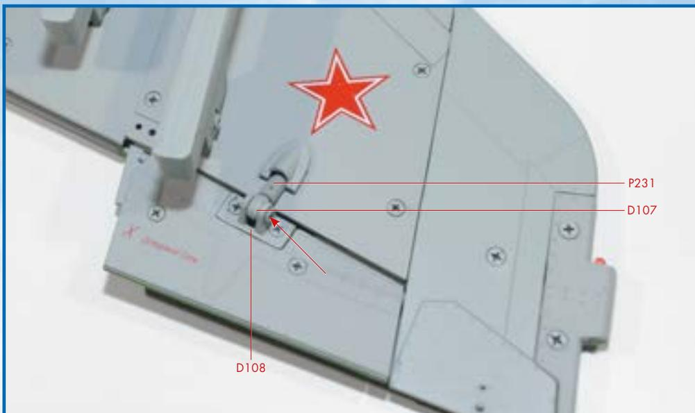
**5** Затем установите шток привода элерона (D107), как показано на снимке, и зафиксируйте его винтом QM.
