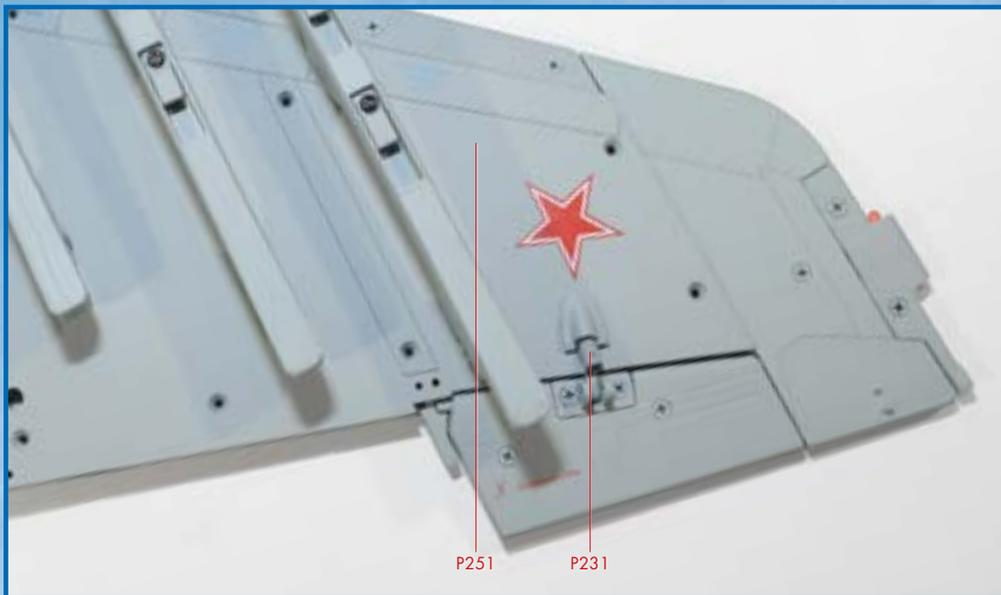
**3** Установите на каркас левой консоли крыла нижнюю поверхность крыла с пилонами, как показано на снимке. Для удобства монтажа рекомендуем предварительно снять обтекатель привода элерона, а затем установить его на место.
